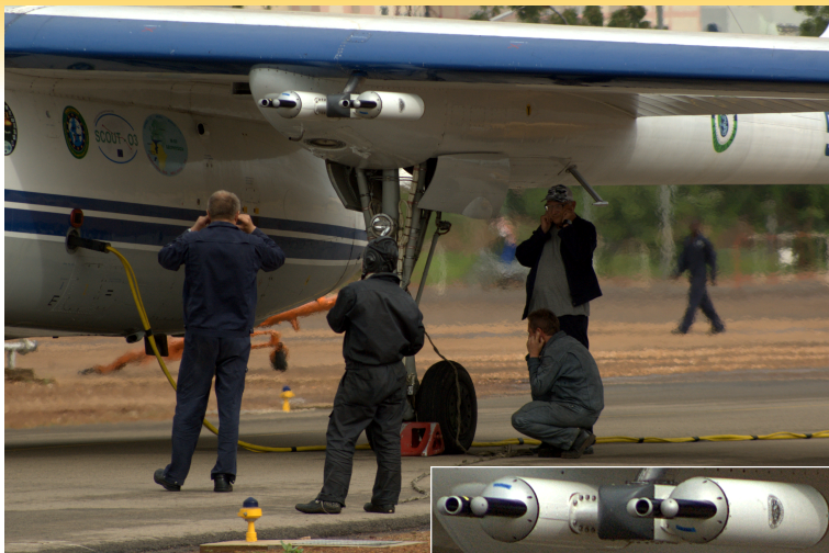
Ryc.: Instrumenty FSSP-100 i FSSP-300 przymocowane pod skrzydłem samolotu M55 Geophysica. (Wagadugu, Burkina Faso, 2006; fot. autor)
