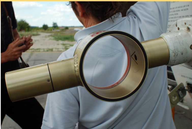
Ryc.: Instrument PVM-100A przymocowany do kadłuba samolotu ATR-42 (Jassy, Rumunia, 2007; fot. autor)
