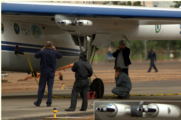
Rysunek: Instrumenty FSSP-100 i FSSP-300 przymocowane pod skrzydłem samolotu M55 Geophysica. (Wagadugu, Burkina Faso, 2006; fot. autor)
