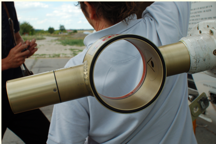
Rysunek: Instrument PVM-100A przymocowany do kadłuba samolotu ATR-42 (Jassy, Rumunia, 2007; fot. autor)
