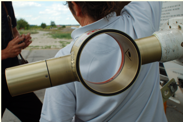
Rysunek: Instrument PVM-100A przymocowany do kadłuba samolotu ATR-42
