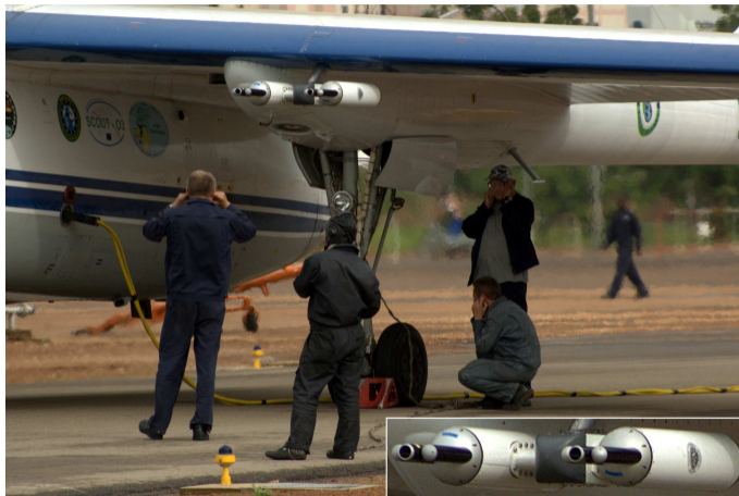
Instrumenty FSSP-100 i FSSP-300 przymocowane pod skrzydłem samolotu M55 Geophysica. (Wagadugu, Burkina Faso, 2006; fot. autor)
