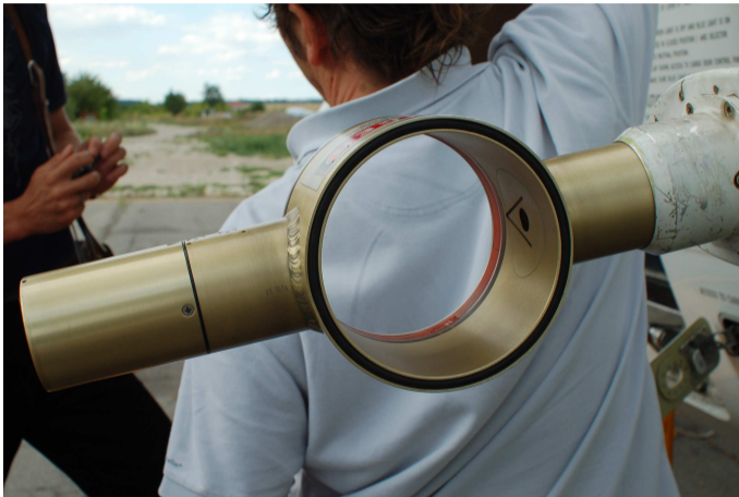
Instrument PVM-100A przymocowany do kadłuba samolotu ATR-42 (Jassy, Rumunia, 2007; fot. autor)
