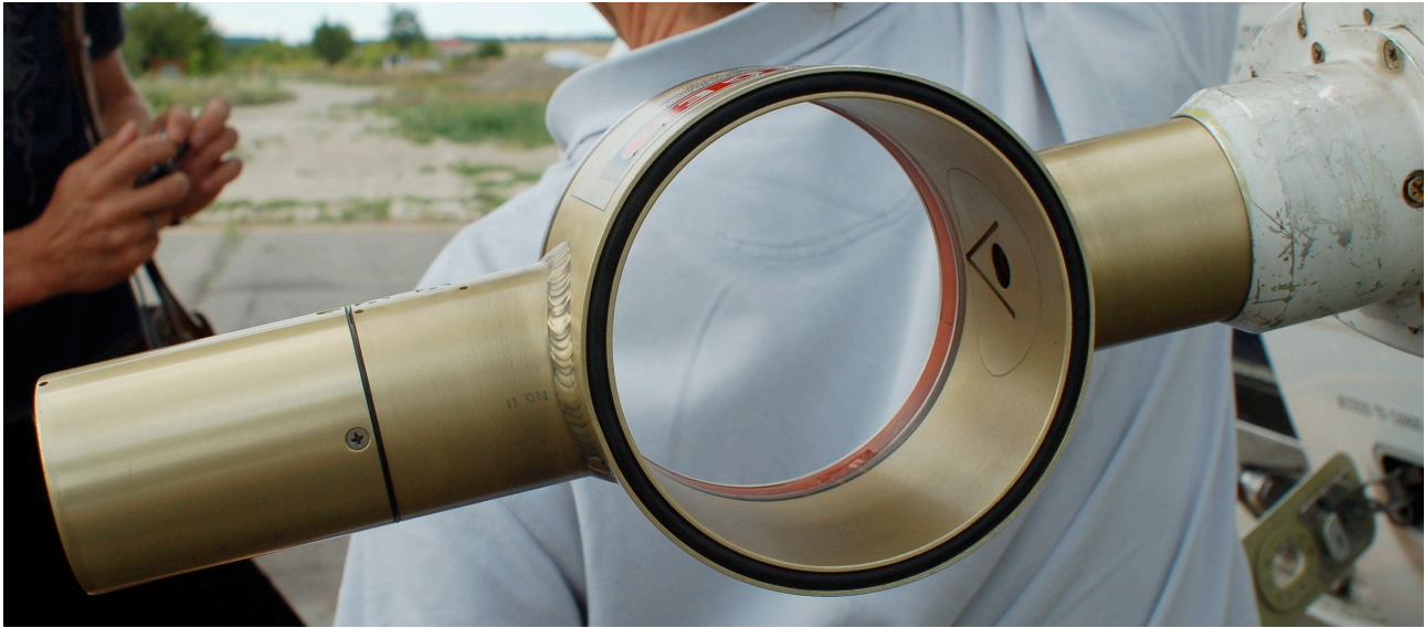
Ryc. 2.5. Instrument PVM-100A przymocowany do kadłuba samolotu SAFIRE ATR-42 (Jassy, Rumunia, 2007; fot. autor)
