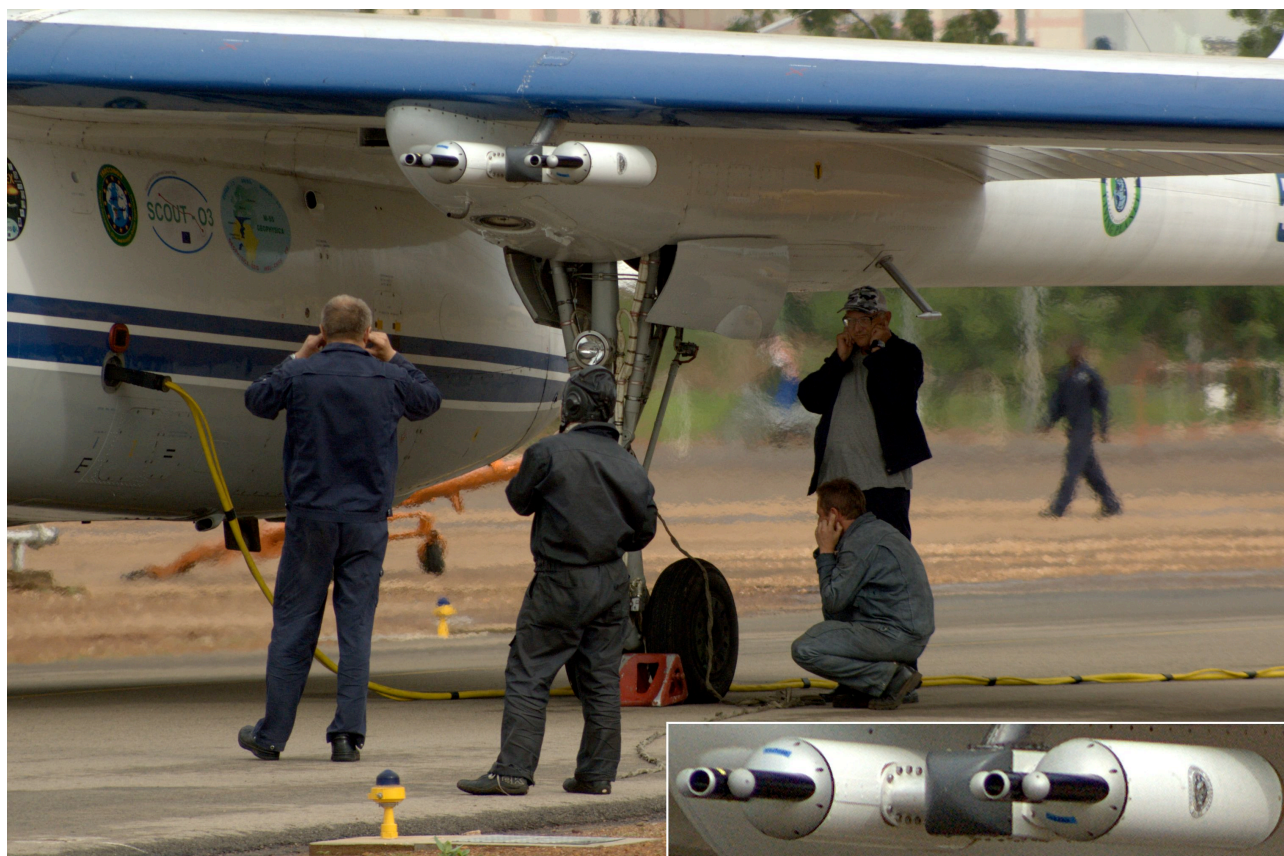
Ryc. 2.2. Instrumenty FSSP-100 i FSSP-300 przymocowane pod skrzydłem samolotu M55 Geophysica. (Wagadugu, Burkina Faso, 2006; fot. autor)
