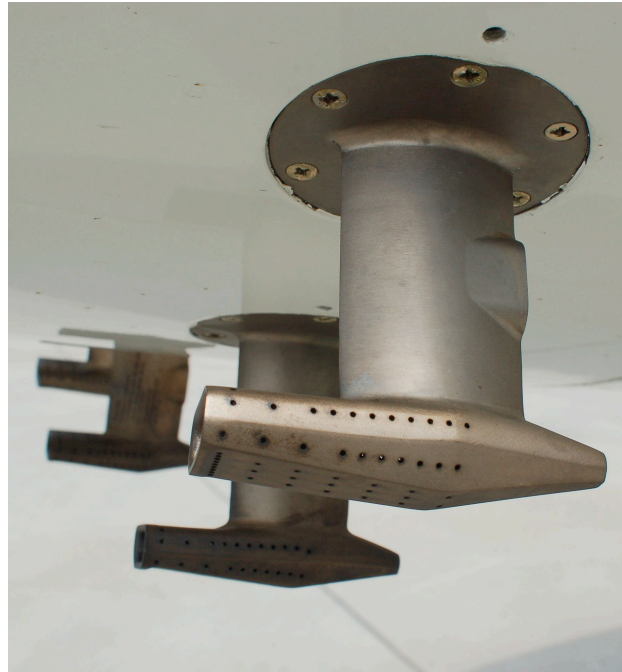
Ryc. 2.10. Obudowy czujników Rosemount przy mocowane do kadłuba samolotu SAFIRE Falcon F-20 (Rotterdam, Holandia, 2008; fot. autor)
