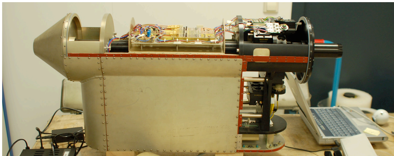
Ryc. 2.4. Instrument X-Probe ze zdjętą obudową podczas korekcji geometrii układu optycznego (Rotterdam, Holandia, 2008; fot. autor)
