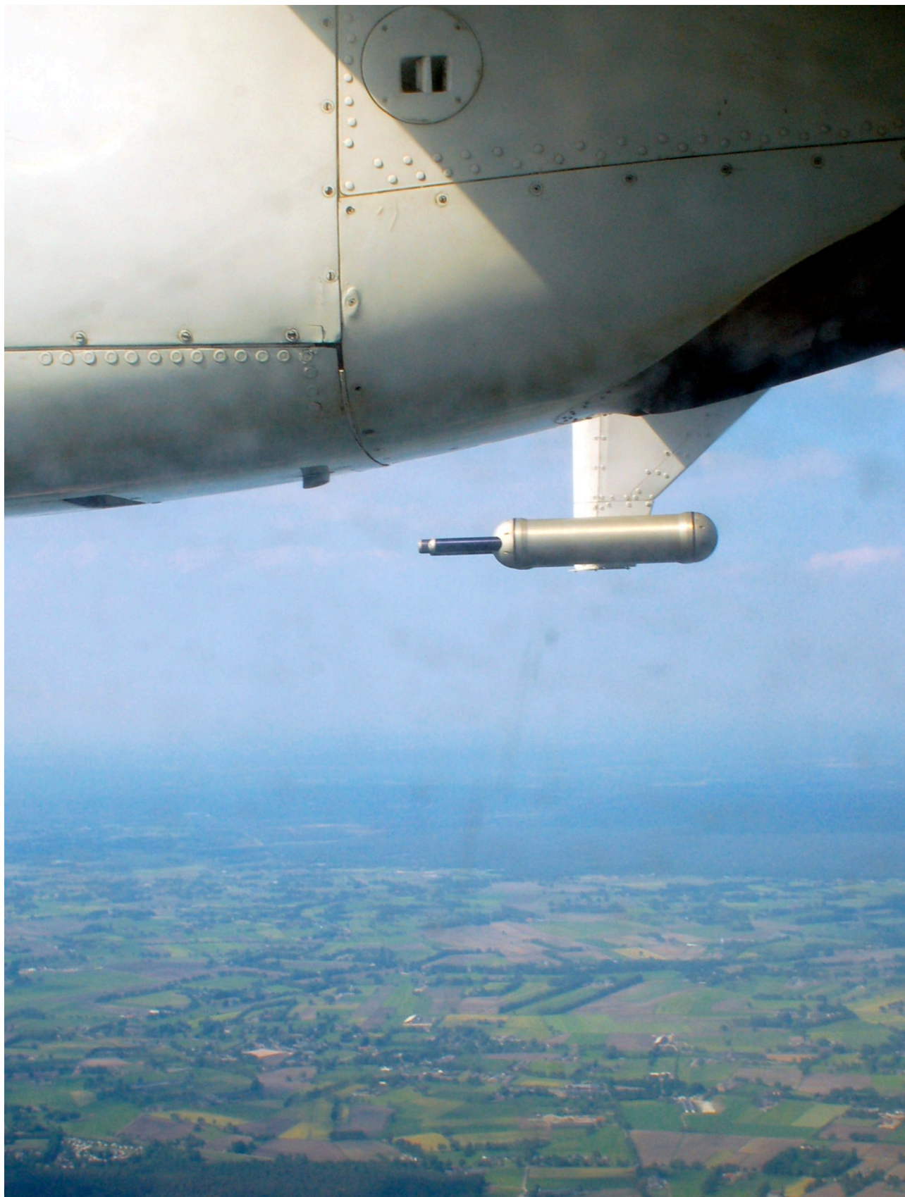
Ryc. 1. Spektrometr kropel chmurowych Fast-FSSP przymocowany pod skrzydłem samolotu SAFIRE ATR-42 (lot badawczy nad Holandią, 2008; fot. autor)
