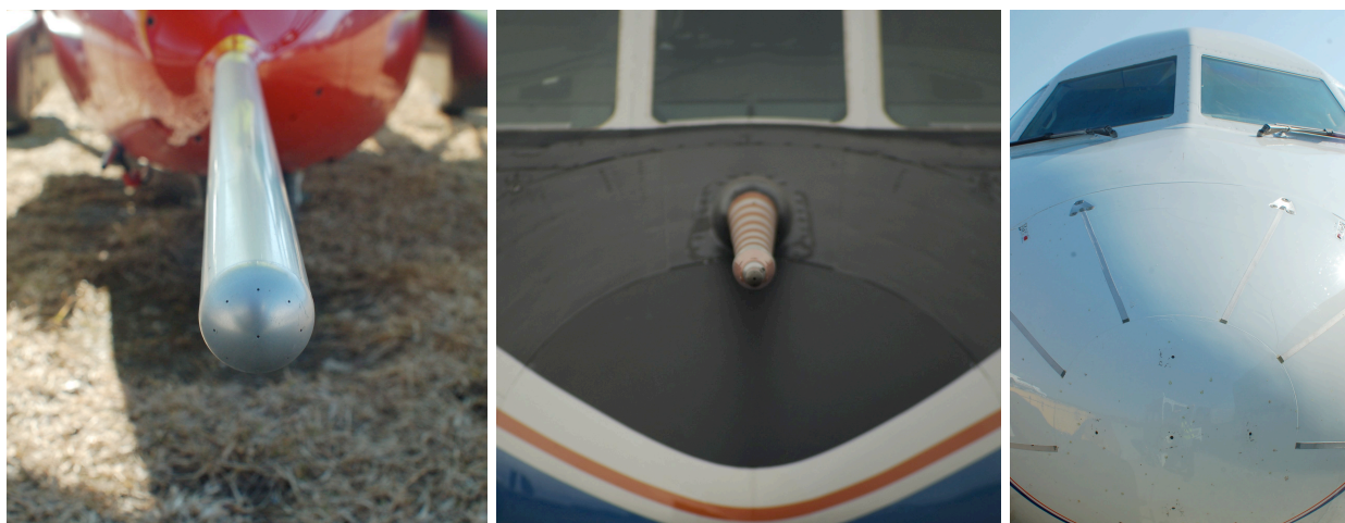
Ryc. 2.15. Otwory do pomiaru ciśnienia na, odpowiednio (od lewej), bomie na nosie motolotni FZK-ENDURO, bomie na nosie samolotu DLR Falcon oraz na nosie samolotu SAFIRE ATR-42 (Niederöblarn, Austria, 2008; Wagadugu, Burkina Faso, 2007; Rotterdam, Holandia, 2008; fot. autor)
