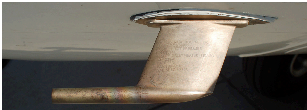
Ryc. 2.14. Rurka Pitota (Rosemount) przymocowana do kadłuba samolotu SAFIRE ATR-42 (Rotterdam, Holandia, 2008; fot. autor)
